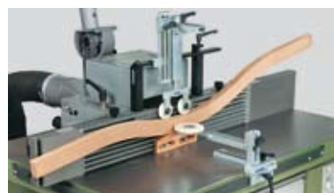
Figura 19. Conducción segura de una pieza curvada en el fresado con el rodillo individual (Fuente: Aigner).
