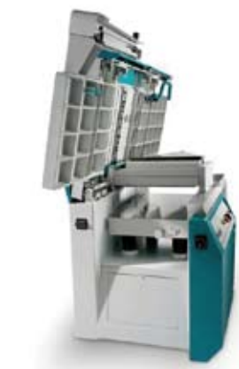
Figura 16. Sistema de apertura de las mesas neumático (Fuente: Griggio).
