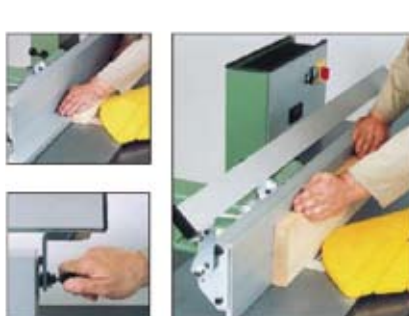
Figura 15. Guía auxiliar para piezas estrechas, y canteado de piezas (Fuente: Panhans).
