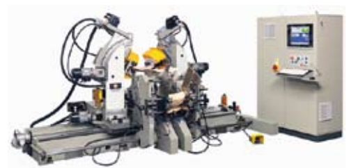
Figura 5. Espigadora programable (Fuentes: Balestrini).
