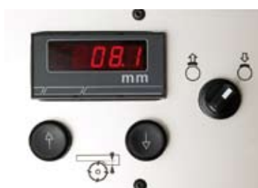
Figura 11. Regulación electrónica del grosor de arranque (Fuente: Panhans).
