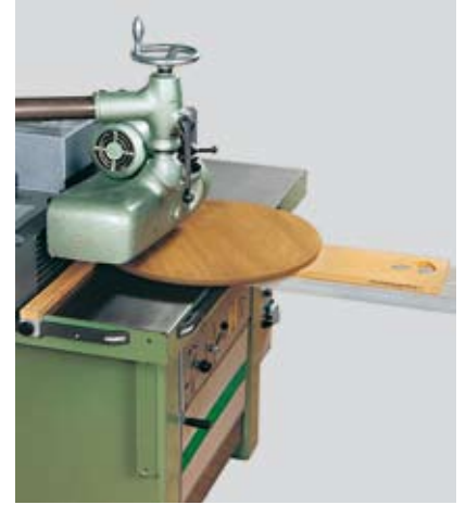
Figura 6. Fresa maestra de círculos y círculo de fresado (Fuente: Aigner).
