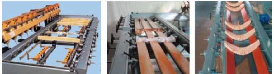
Figura 4. Accesorios para la fijación de piezas en la copiadora de talla (Fuente: Andreoni).
