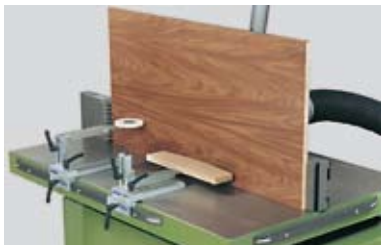
Figura 15. Fresado de un tablero vertical con rodillo y patín de presión (Fuente: Aigner).
