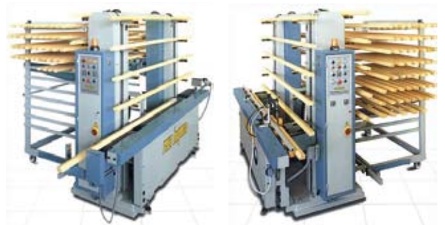
Figura 11. Apiladora y desapiladora de listones y varillas (Fuente: Renzo Borgonovo).
