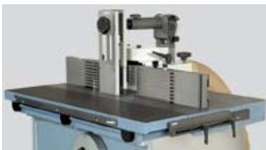
Figura 2. Carriles de fijación (Fuente: Aigner).
