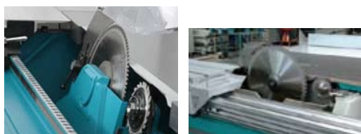
Figura 12. Sistemas rápidos de cambio de disco (Fuentes: Martin y Griggio)
