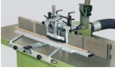
Figura 20. Fresado de una pieza fina y estrecha en la regla adicional con placas de presión y patín oscilante (Fuente: Aigner).
