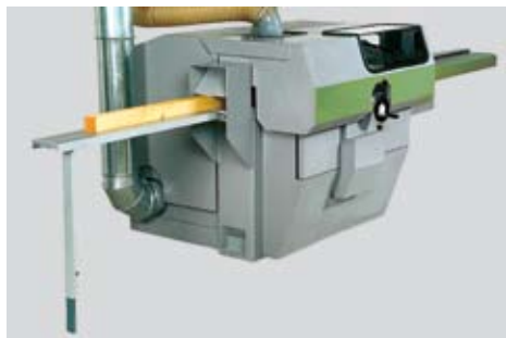
Figura 2. Prolongaciones de mesa para moldureras (Fuente: Aigner).
