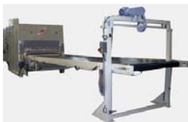
Figura 5. Mesa de salida de prensa (Fuente: March).
