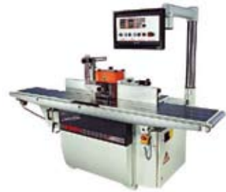
Figura 21. Tupí dotada de sistema de reconocimiento
