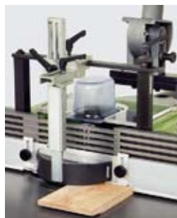
Figura 16. Aplanado de una pieza pequeña con patín semicircular (Fuente: Aigner).
