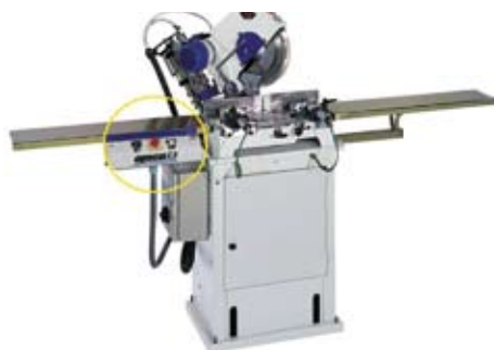
Figura 8. Ingletadora con parada de emergencia (Fuente: Omgga).
