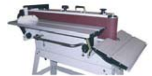
Figura 7. Ayuda para el lijado de radios pequeños (Fuente: Felder).
