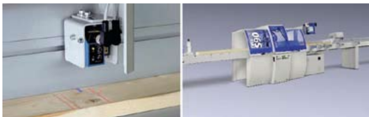
Figura 1. Tronzadora con detección automática de defectos (Fuente: Weinig).
