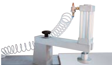
Figura 4. Prensa y mordazas (Fuentes: Griggio, Martin y Altendorf).
