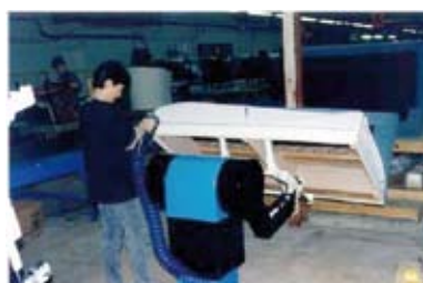
Figura 2. Posicionador de sofás y mesa de grapado (Fuente: desconocida, Stanley Bostitch).
