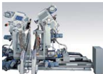
Figura 3. Espigadora doble (Fuente: Bacci).
