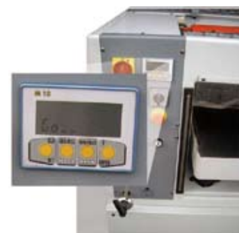
Figura 7. Visor digital (Fuente: Woodman).
