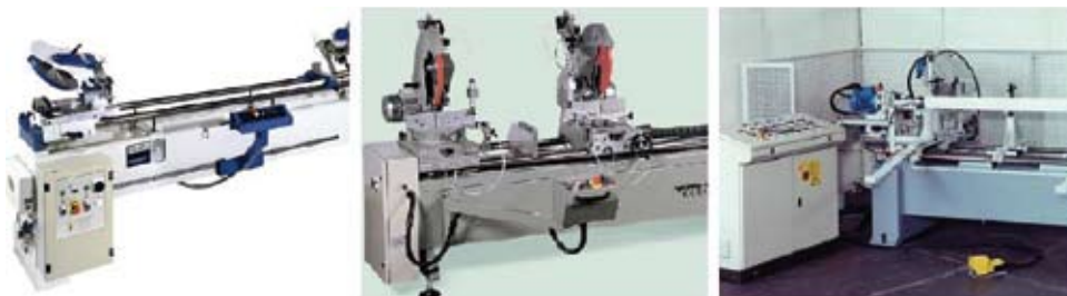
Figura 3. Diferentes configuraciones de mandos en función de su ubicación (Fuentes: Omga, Compa, Essepigi).
