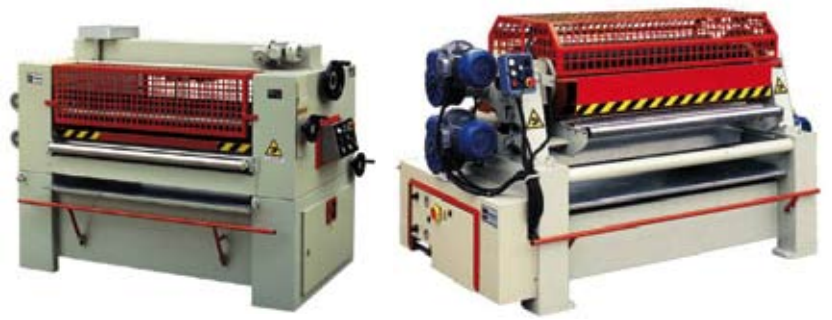
Figura 5. Encoladoras dotadas de rodillos (Fuente: Osama).
