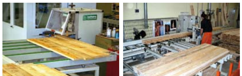
Figura 5. Sistemas de acumulación a la entrada y salida de máquinas (Fuente: Bottene).
