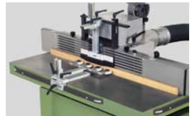
Figura 17. Fresado de un listón con patín oscilante y rodillo cuádruple (Fuente: Aigner).
