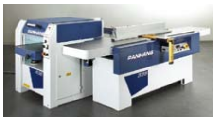
Figura 9. Enlace de dos máquinas-procesos (Fuente: Panhans).
