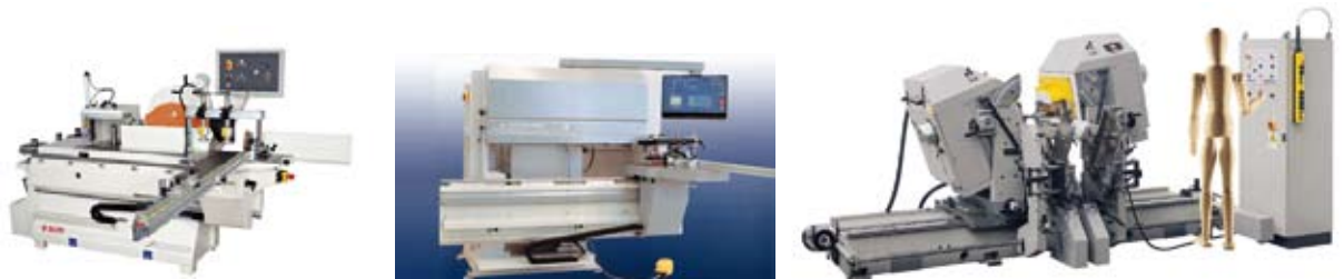
Figura 4. Diferentes disposiciones de panel de mandos en la espigadora (Fuentes: SCM, Colombo Angelo, Balestrini).
