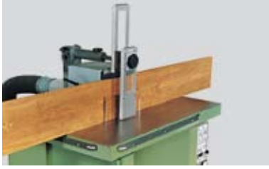
Figura 5. Fresado de una pieza en posición vertical (Fuente: Aigner).
