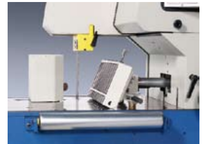
Figura 7. Alimentadores de piezas para sierra de cinta (Fuentes: Agazzani, Griggio, Weinig).
