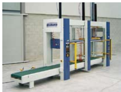
Figura 2. Prensas automáticas autoregulables (Fuentes: Ramarch, S.I.T.I di Basso).
