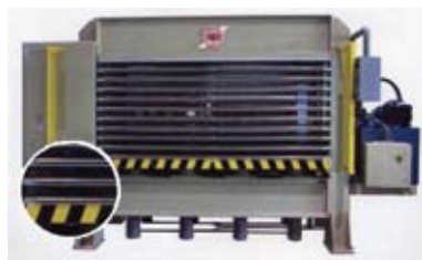
Figura 2. Platos dotados con rodillos (Fuente: March).
