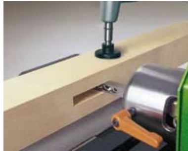
Figura 4. Taladros con portabrocas especial (Fuente: Felder).
