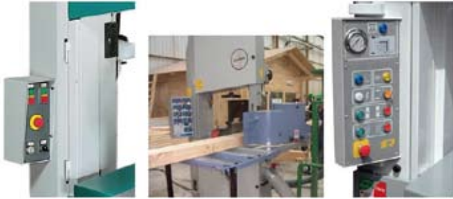
Figura 9. Mejora de la visibilidad de los dispositivos de información y mando (Fuentes: Griggio, Meber, Agazzani).
