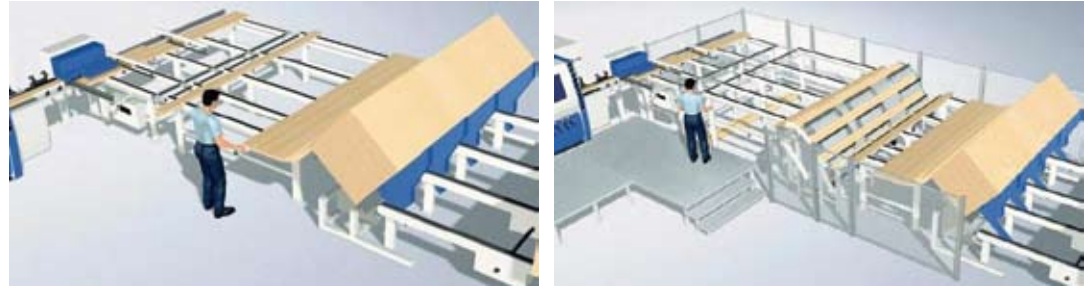
Figura 5. Alimentación de la moldurera (Fuentes: Weinig).
