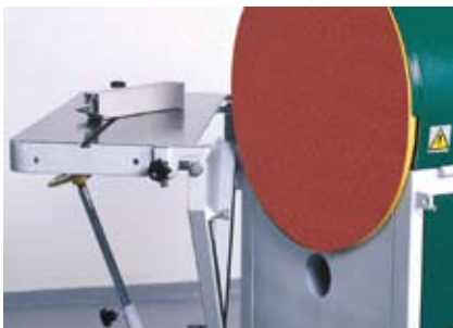
Figura 10. Accesibilidad a la lija (Fuente: Rojek).
