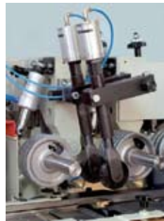
Figura 6. Rodillos prensores (Fuente: Weinig).
