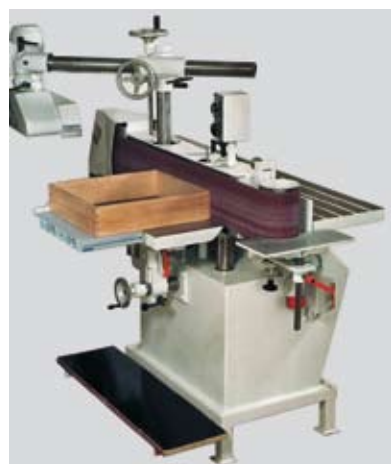
Figura 2. Mesa flotante (Fuentes: Aigner)
