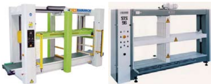
Figura 2. Prensas automáticas autoregulables (Fuentes: Ramarch, S.I.T.I di Basso).
