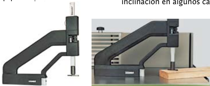
Figura 22. Distómetro. Medición de un espesor directamente sobre la superficie de trabajo (Fuente: Aigner).
