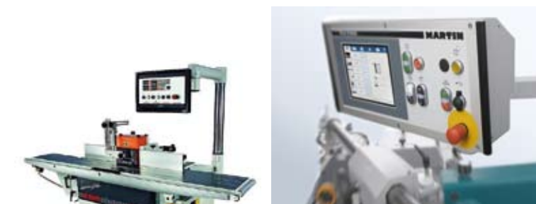
Figura 12. Paneles de mandos con pantallas LCD (Fuentes: SCM, Martin).
