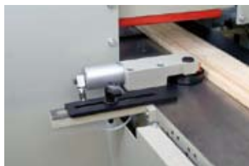
Figura 1. Rodillo prensor lateral (Fuente: Weinig).
