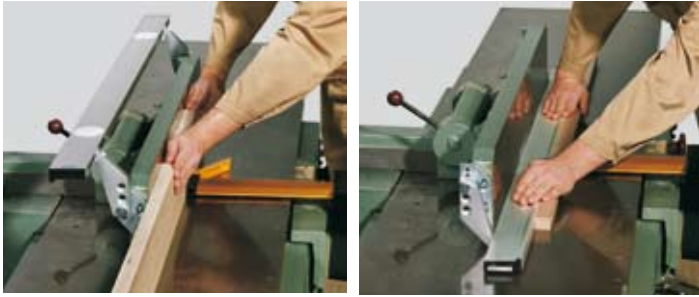
Figura 13. Cepillado fácil y seguro con el tope auxiliar. (Fuente: Aigner).
