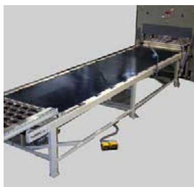
Figura 4. Mesa de entrada a prensa (Fuente: March).
