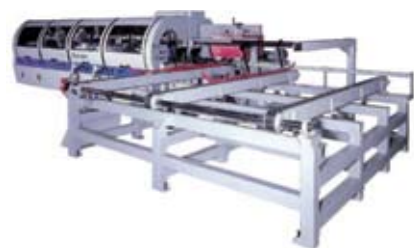
Figura 4. Alimentación de la moldurera (Fuentes: Linnerman, Weinig).
