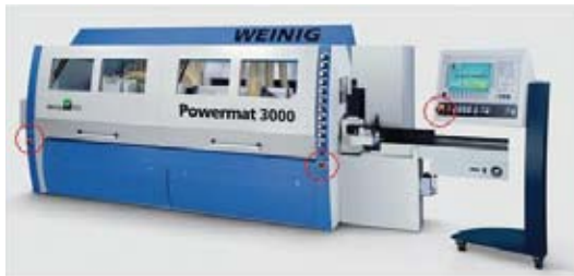
Figura 10. Moldurera con 3 localizaciones de la parada de emergencia (Fuente: Weinig).
