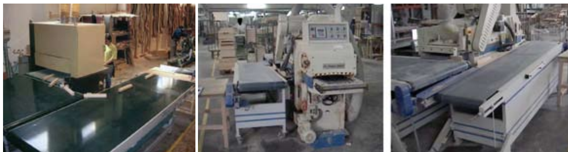
Figura 5. Sistemas de retorno de piezas (Fuente: Maquinaria La Fonteta, Empresa participante en el estudio campo).
