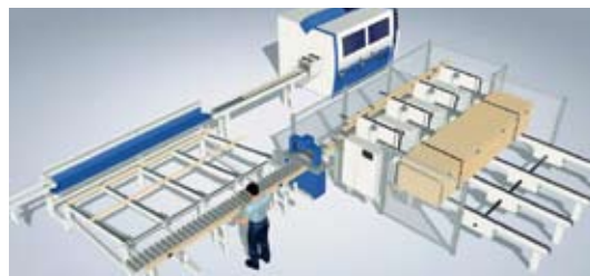
Figura 7. Descarga de las piezas en la moldurera (Fuente: Weinig).
