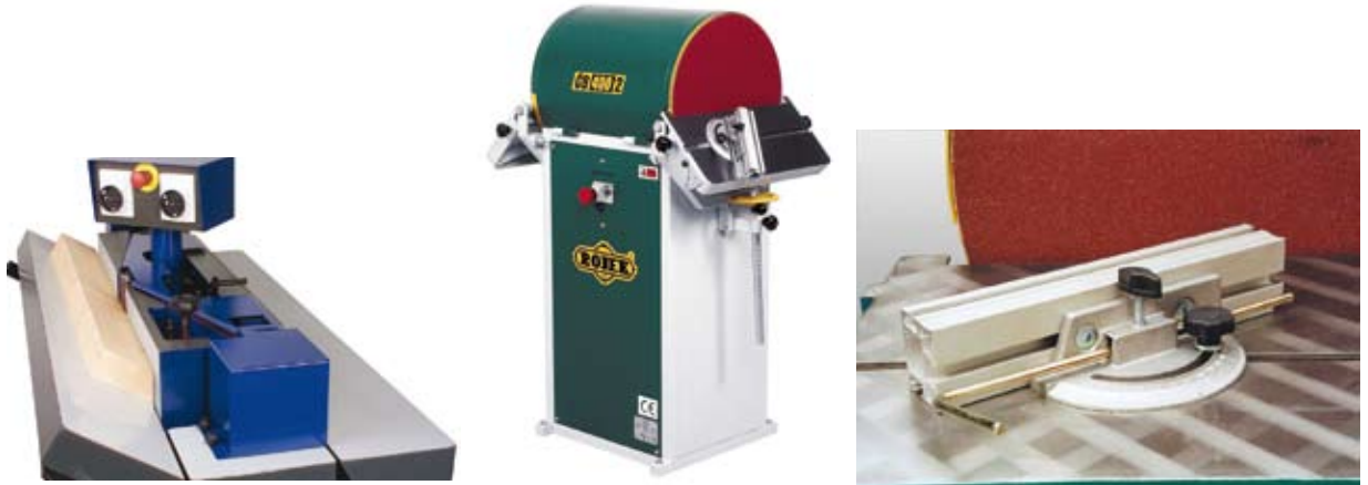
Figura 5. Ayudas para el lijado de en ángulo y a escuadra (Fuentes: Felder, Rojek).
