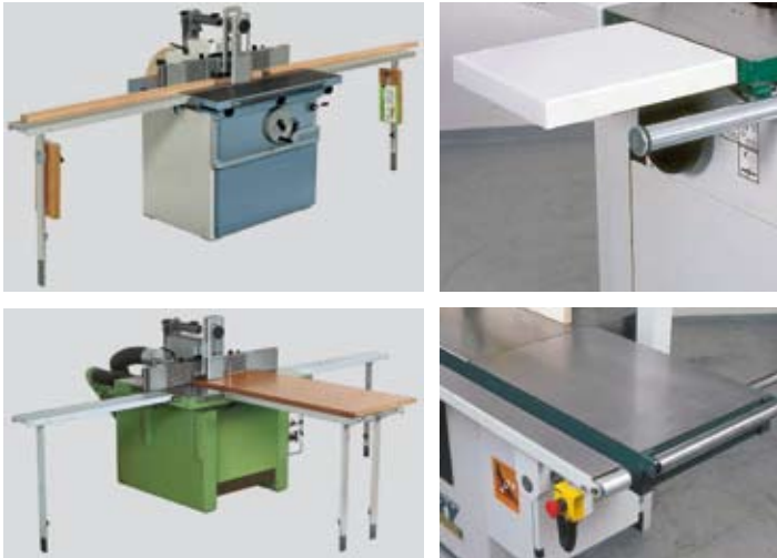
Figura 1. Prolongaciones de la bancada (Fuente: Aigner, Rojek).
