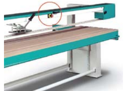
Figura 5. Parada de emergencia situada en una posición intermedia de la lijadora (Fuente: Griggio).
