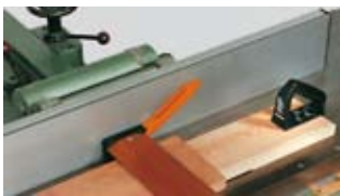
Figura 14. Empujador Quickly (Fuente: Aigner).
