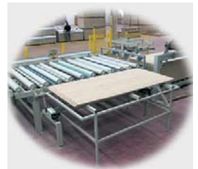
Figura 7. Verificador de tableros (Fuente: March).
