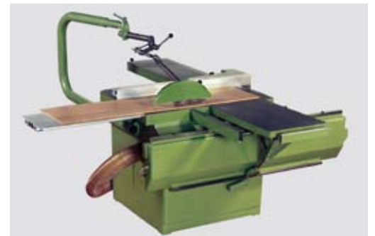
Figura 14. Mesa flotante (Fuente: Aigner).
