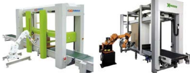
Figura 5. Prensas con robot (Fuentes: Ramarch, Biesse).
