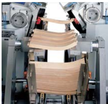
Figura 1. Cargador para la alimentación de piezas en espigadora (Fuente: Bacci).
