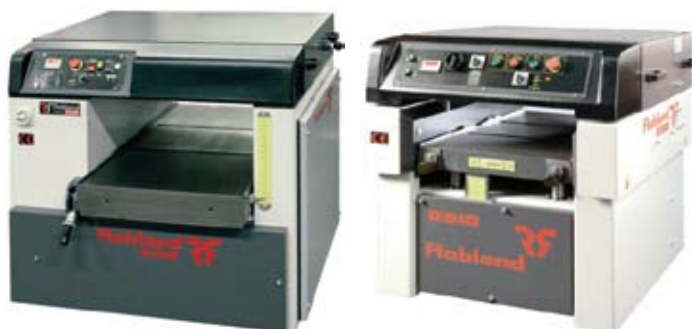
Figura 6. Mandos inclinados para mejorar la visibilidad (Fuente: Robland).
