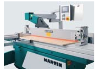
Figura 7. Escuadradora dotada de carro motorizado y barra de prensado.
