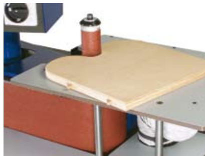
Figura 6. Ayuda para el lijado de radios pequeños (Fuente: Felder).
