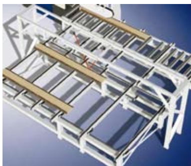
Figura 3. Sistema de medición y alimentación automático (Fuente: RaiMech).
