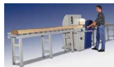
Figura 7. Tronzadora con doble mando manual (Fuente: Weinig).
