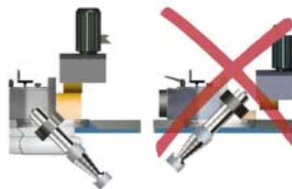
Figura 25. Inclinación del eje “hacia atrás” (Fuente: Felder).
