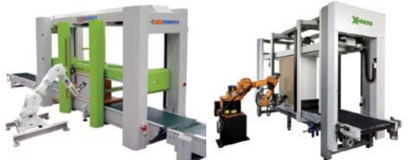
Figura 7. Prensa de montaje con robot de grapado (Fuentes: Ramarch, Biesse).
