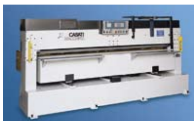
Figura 5. Guillotina dotada de mesa móvil para el ajuste de la distancia de corte (Fuente: Casati Macchine, Josting).
