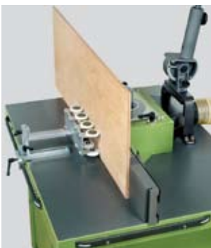
Figura 18. Fresado de una tabla fina con rodillos guía (Fuente: Aigner).
