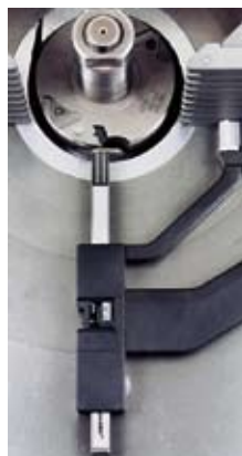
Figura 24. Ajuste de la herramienta a la profundidad de fresado deseada (Fuente: Aigner).
