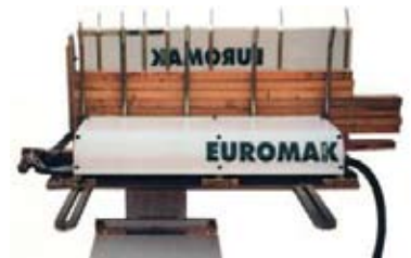
Figura 6. Cargadores y alimentadores verticales (Fuentes: Euromak., Weinig).
