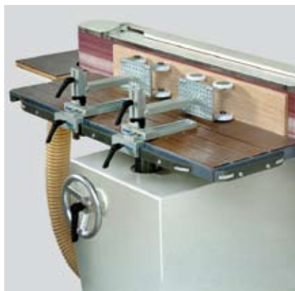
Figura 4. Rodillos de guía (Fuente: Aigner).
